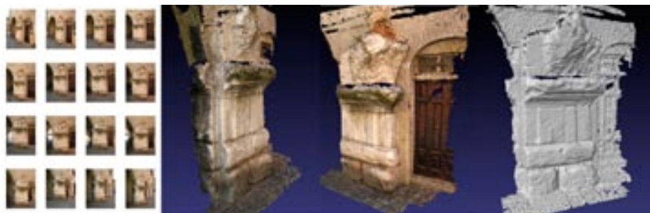
Fig. 1 – Esempi di oggetti 3D generati dal sistema ARC3D (elaborazione dati effettuata con MeshLab).
