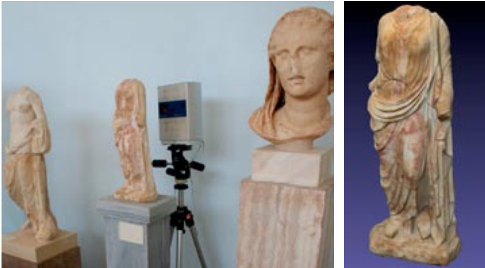
Fig. 2 – Lo scanner NextEngine al lavoro ed il modello prodotto.
